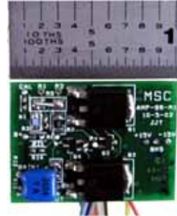
型号 AMP-SG1-M1 (单通道应变仪放大器)
